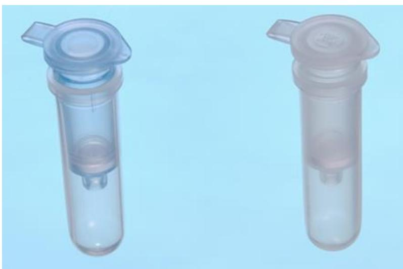
**Slika 4.3:** DNK i RNK *spine columns* sa selektivno propustljivim membranama
