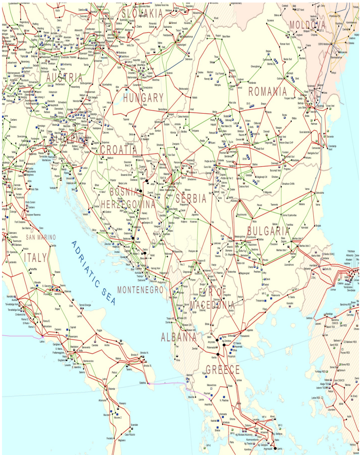
Prilog 7.4. Geografska karta elektroenergetskog sistema Srbije, Crne Gore i Albanije - naponski nivo 400kV i 220kV
