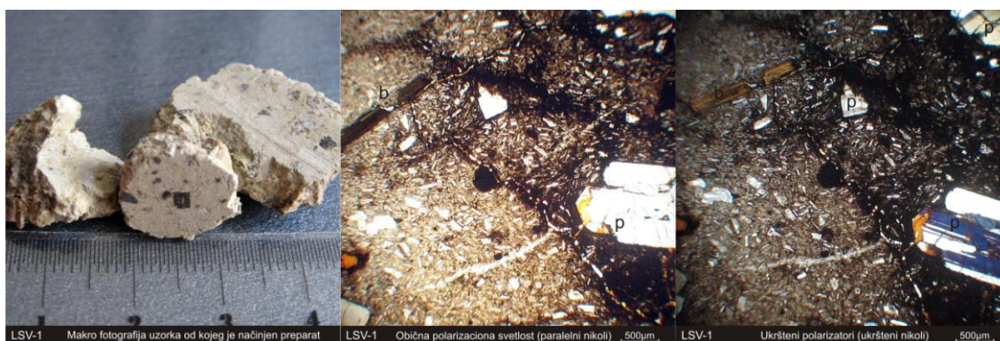
Slika 38. – Mikrofotografije petropreparata uzorka matičnih stena pojave juvelirskog kamena Sokolov vis. p – plagioklas, h – hornblenda, b – biotit.
