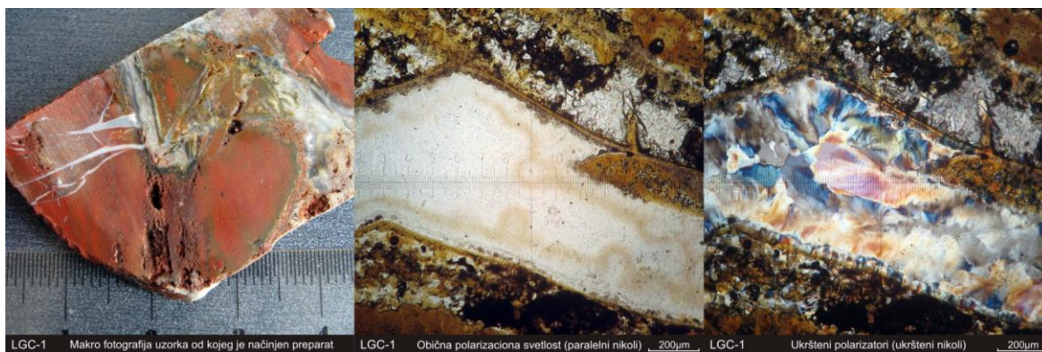
Slika 26. – Mikrofotografija brečiziranog crvenog jaspisa (s leva na desno: makrofotografija uzorka od kojeg je izrađen petropreparat, mikrofotografija petropreparata sa paralelnim nikolima i sa ukrštenim nikolima).
