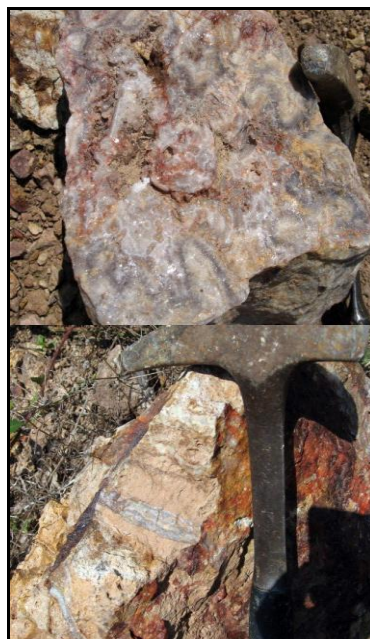
Slika 44. – Izgled juvelirske mineralne sirovine (gore) i alterisanog (silifikovanog) andezita prožetog kvarcnim žilicama (dole)
