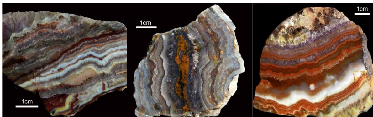
Slika 91. – Upoređenje uzoraka ahata sa zonarnom strukturom u kojima se smenjuju zone kalcedona i kvarca (ametista) iz nalazišta (s leva na desno) Rasovača, Mehane II i Halsbach u Nemačkoj (iz Zenz, 2011).
