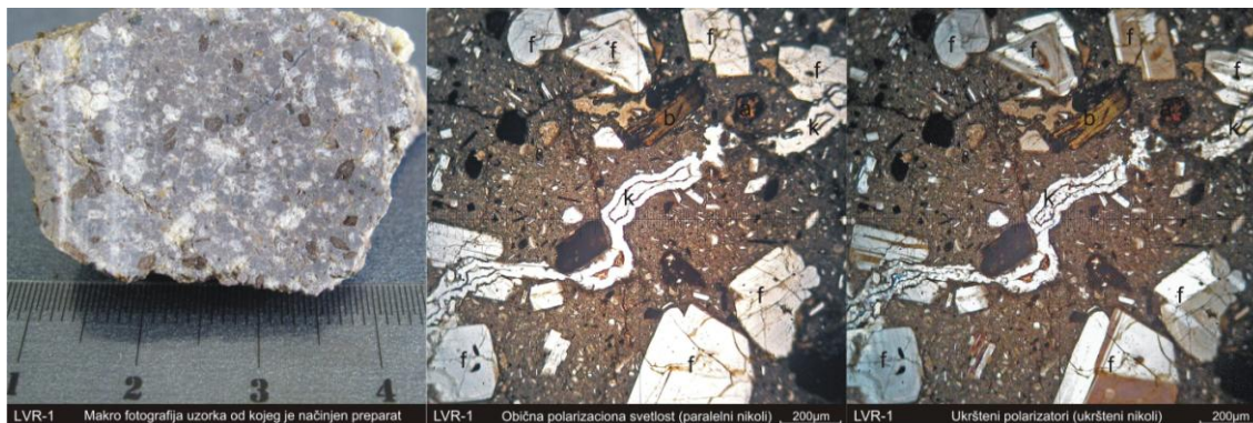
Slika 23. – Mikrofotografija petropreparata hornblenda andezita sa ležišta Vrtače (s leva na desno: makrofotografija uzorka od kojeg je izrađen petropreparat, mikrofotografija petropreparata sa paralelnim nikolima i sa ukrštenim nikolima). f – feldspat, a – amfibol, b – biotit, k – kvarc.
