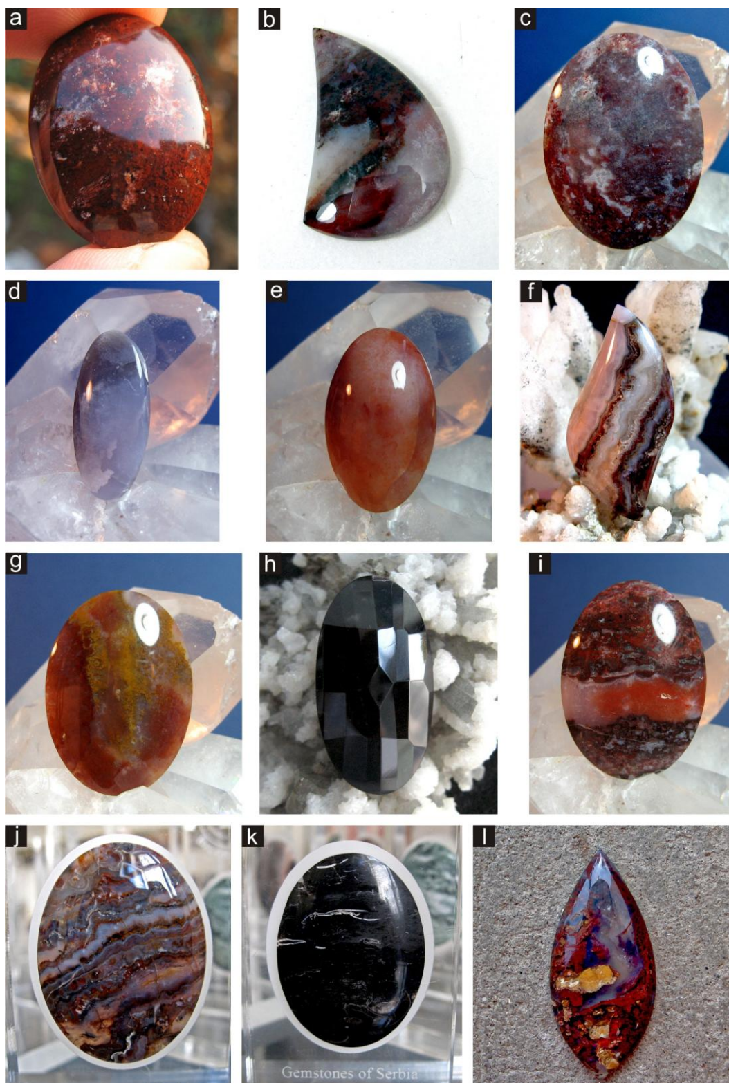
Slika 86. — Rezultati obrade juvelirskih mineralnih sirovina leckog vukanskog kompleksa II: a) crveni jaspis (ovalni kabošon, 30x22mm, Kameno Rebro); b) jaspis („free form“ kabošon, 40x30mm, Vrtače); c) jaspis-ahat (ovalni kabošon, 30x22mm, Bučumet); d) plavi kalcedon (izduženi ovalni kabošon, 18x8mm, Vrtače); e) karneol (ovalni kabošon, 26x16mm, Kameno rebro); f) ahat („free form“ kabošon, 38x20mm, Mehane II); g) jaspis-kalcedon (ovalni kabošon, 30x22mm, Vrtače); h) crni kalcedon (izduženi ovalni fasetirani kabošon, 36x20mm, Velika Kosanica); i) crveni mahovinasti jaspis (ovalni kabošon, 40x30mm, Vrtače); j) ahat (ovalni kabošon, 40x30mm, Mehane II); k) crni fosilizovani kalcedon (ovalni kabošon, 40x30, Kosanica); l) ahat-jaspis (pendelok kabošon, 35x18mm, Velika Kosanica).
