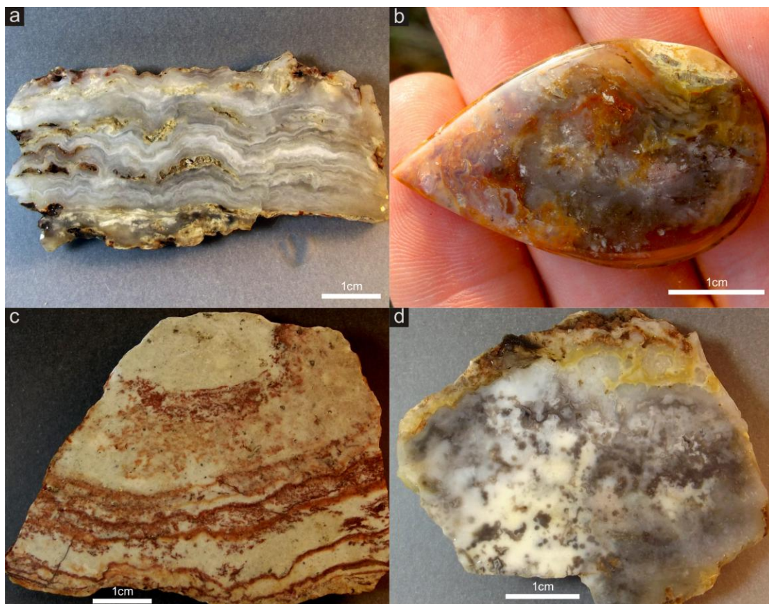
Slika 70. Varijeteti juvelirskog kamena iz nalazišta Mehane I; a) trakasti prozračni kalcedon sa povišenim stepenom poroznosti; b) višebojni kalcedon; c) silifikovani „pejzažni“ andezitski tuf; d) sferoidalni belo-sivo-plavičasti kalcedon.
