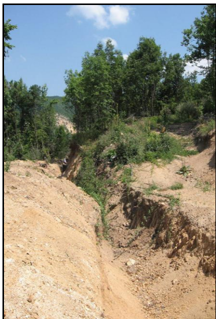
Slika 43. – Istražni geološki raskop na pojavi Ždraljevići
