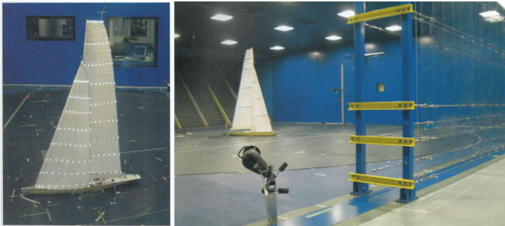
Слика 2.13. Приказ мерења аеродинамичких сила у ваздушном тунелу [11]
