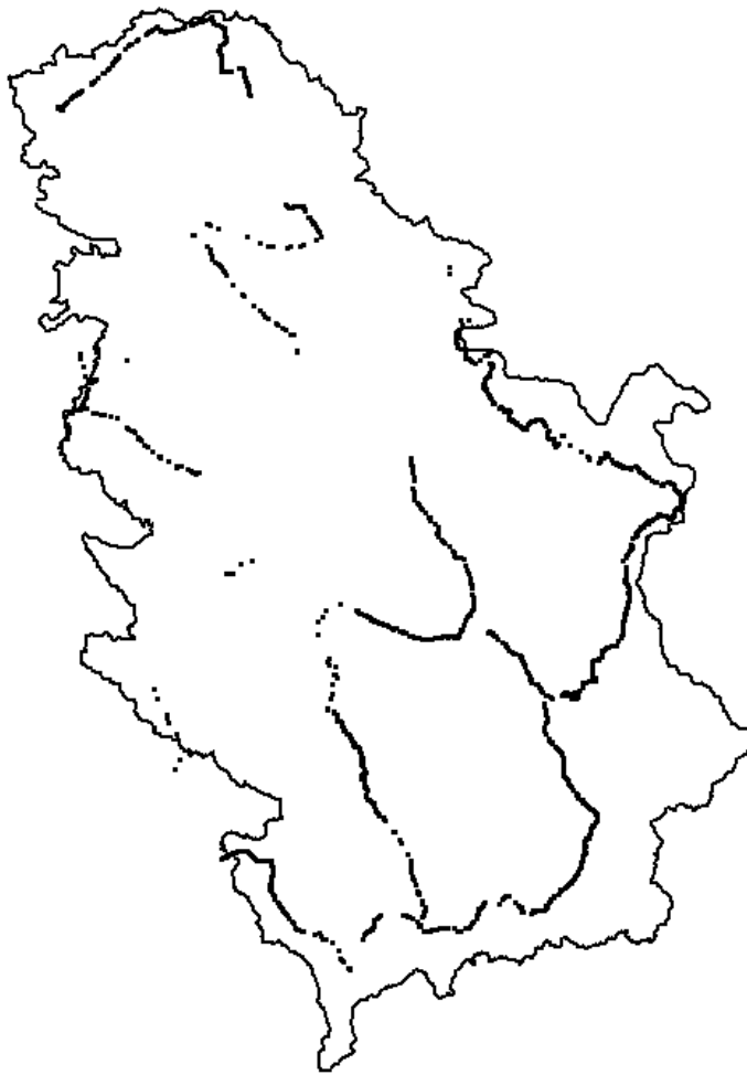
Слика 6.7: Просторни распоред заједничких репера мрежа НВТ1 и НВТ2
