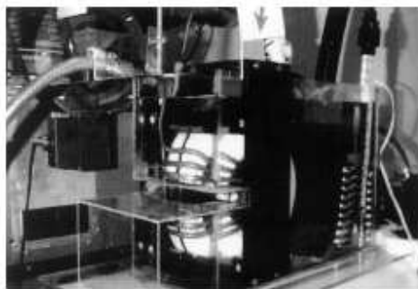
Slika 4.1.3. Prototip mašine za tretman naizmeničnim magnetnim poljem sa frekvencijom od 500 kHz i amplitudama do 10 kA/m. Vazdušni zazor magnetnog jezgra od 20 mm, je pogodan za tretiranje miševa i drugih malih životinja. Zbog različitog poprečnog preseka tela i provodnosti tkiva, na ljudskim bićima bi trebalo koristiti niže frekvencije, tj. 50-100 kHz [Jordan A., 1999].
