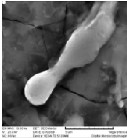
Слика 2.12 СЕМ фотографија ближе периферије легуре Тl-6-4 после деловања 10 импулса наносекундног ХеСl ласерског зрачења [32].
