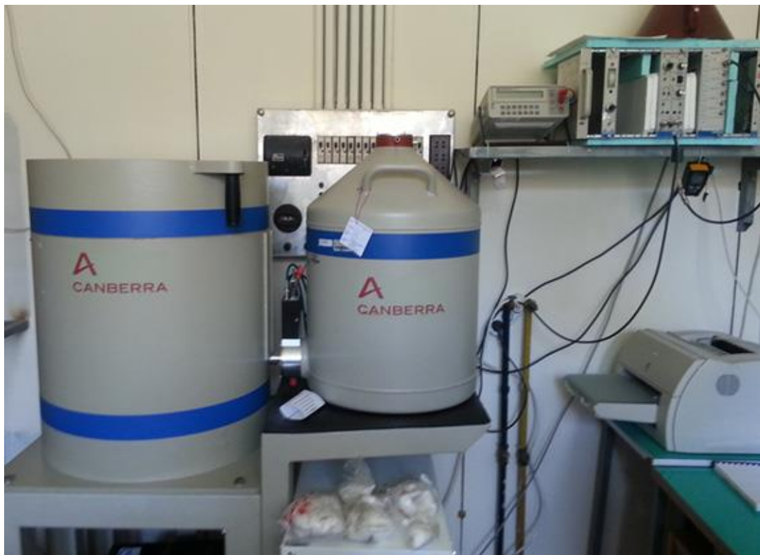
Сл. 8.3 Канберин систем за гама спектрометрију
