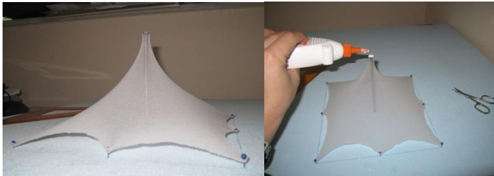
Слике 55а и 55б – фиксирање потпорне тачке једноставног мембранског крова (извор: аутор)
