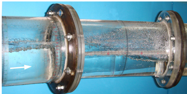
Слика 6.4 - Мехурићи ваздуха на воденој површини који се јасно издвајају при мањим брзинама тока
