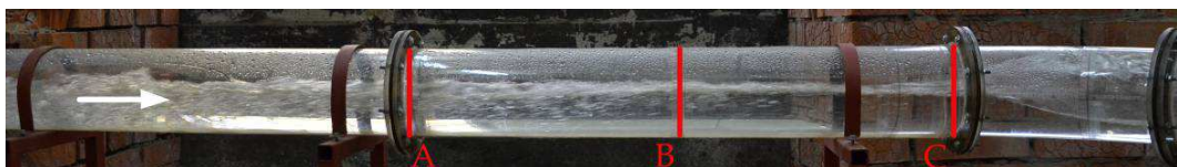
Слика 6.2 - Увлачење ваздуха у ток узводно од кривине
