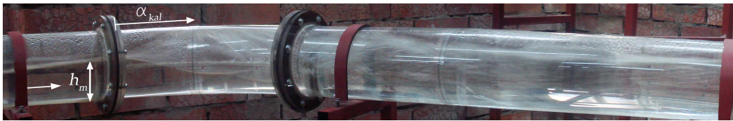
Слика 9.4 - Хеликоидно течење на моделу D/R = 1/3 и \alpha = 60^\circ (Опит бр. 6)
