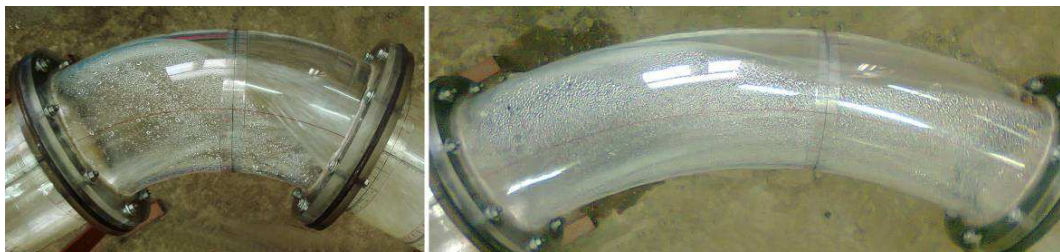
а) Прелазно течење за D/R = 1/2 б) Течење без окретања млаза за D/R = 1/4
