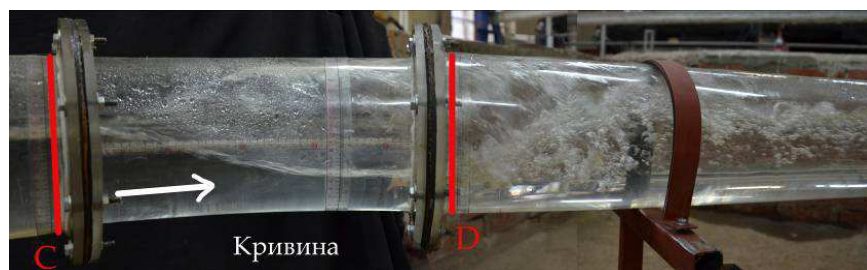
Слика 6.1 – Интензивно увлачење ваздуха у ток при окретању млаза
