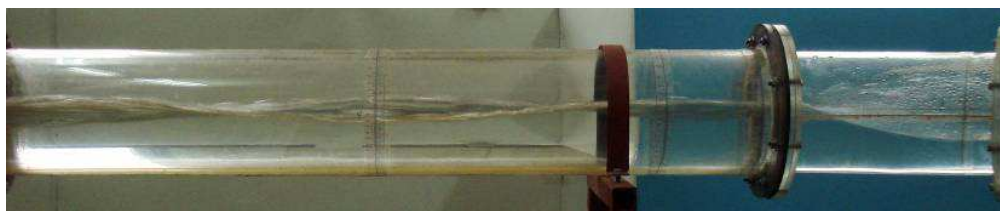
б) Поремећаји узводно од кривине у прихватљивим границама
