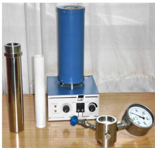
Slika 4.2. Autoklav ( Roth Karlsruhe , T_{\max} = 300 °C, p_{\max} = 300 bar) u laboratoriji Instituta za multidisciplinarna istraživanja.
