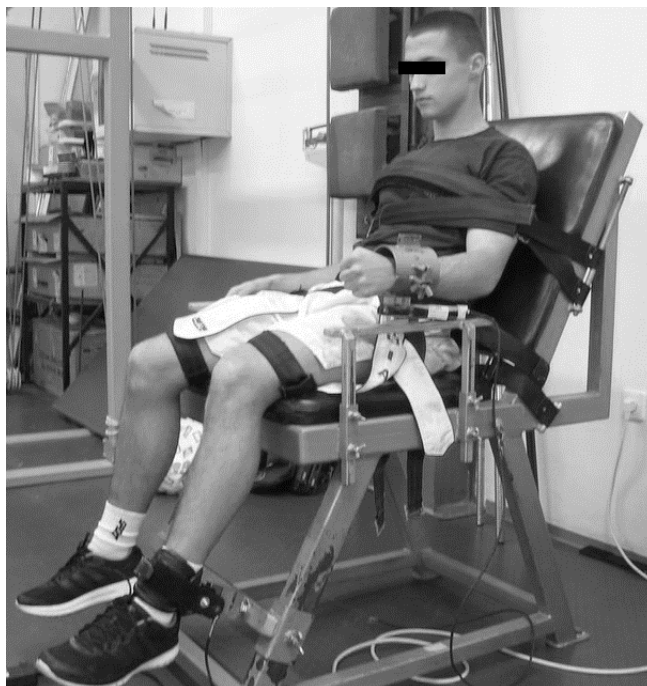
Slika 6. Položaj ispitanika za vreme testiranja u delu eksperimenta gde je bilo potrebno da se dobiju podaci vezani za vrednosti F_{max} u STS, kao i za vrednosti F_{max} pri UMK posmatranih mišića ruku i nogu
