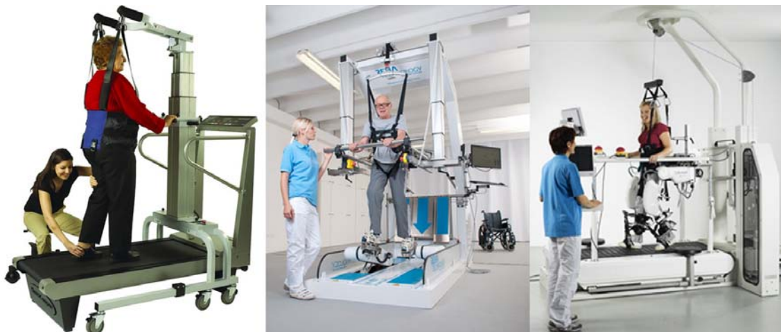
Слика 1.1 Роботски системи за рехабилитацију хода: покретна трака (GaitKeeper) са LiteGait подршком телу пацијента (слика лево), G-EO System (слика у средини) и Locomat (слика десно).
