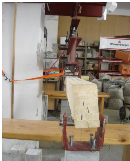
Слика 103. Гњечење влакана код ослонаца Слика 104. Вертикалне пукотине у дрвеним ламелама
