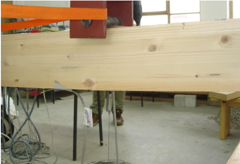
Слика 109. Гњечење влакана код левог ослонца Слика 110. Гњечење влакана код десног ослонца
