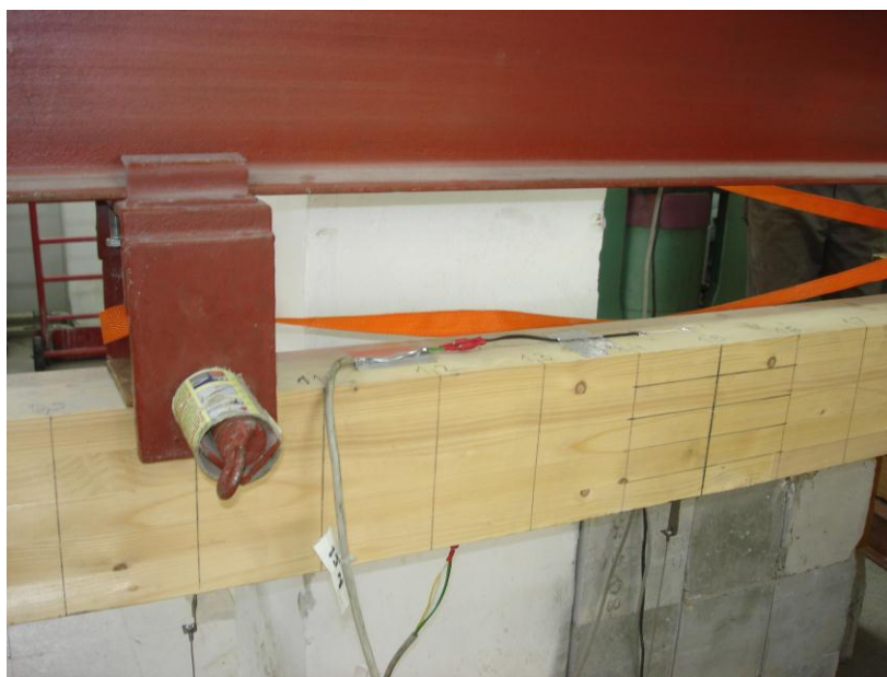
Слика 51. Идеално равно налегање Слика 52. Положај постављених мерних трака на греди
