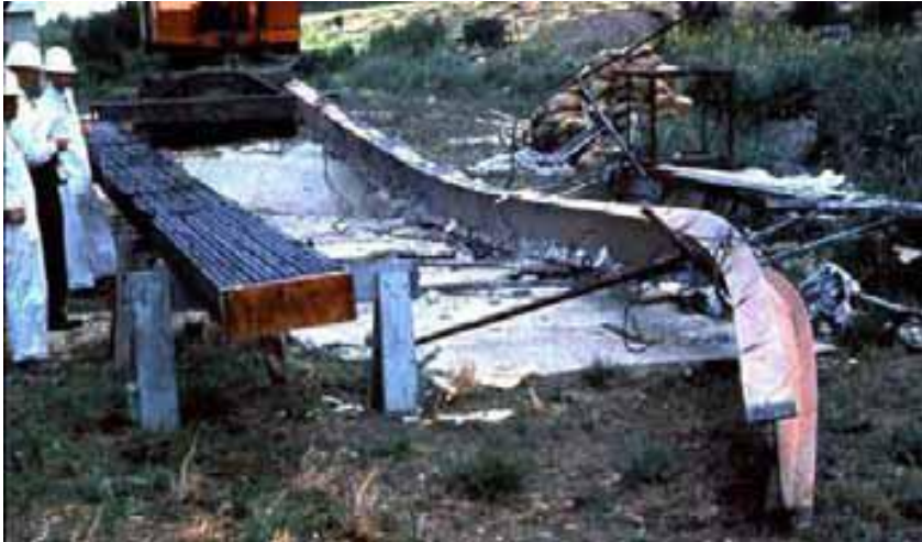
Слика 6. Изглед дрвеног и челичног носача после пожара [75]
