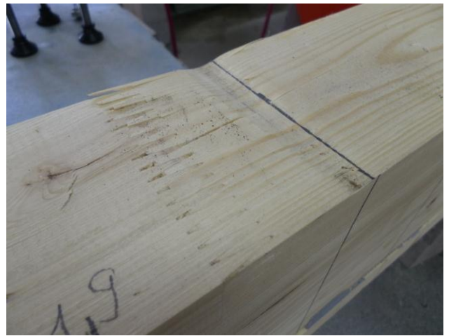
Слика 97. Гњечење дрвета код уноса силе
