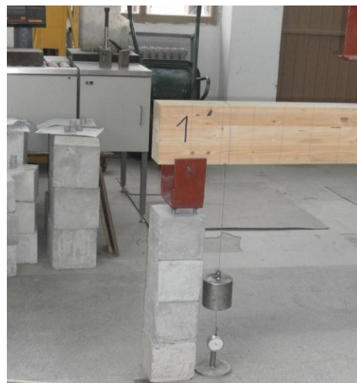
Слика 31. Детаљ ваљкастог ослањања узорка
