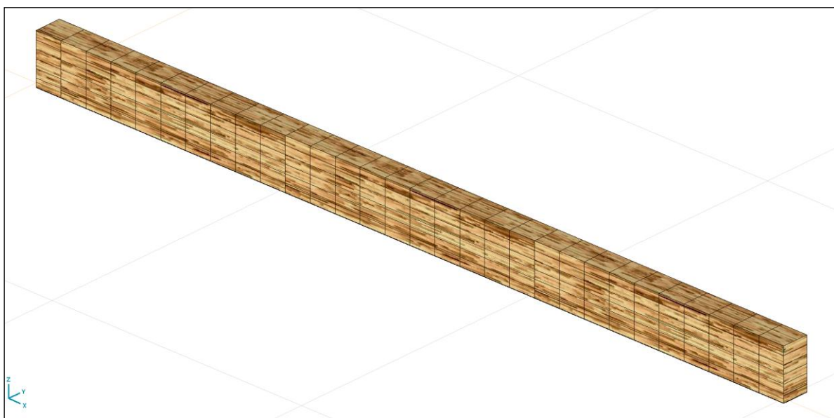
Слика 133. Рендеровани приказ 3D МКЕ модела типичне испитиване ламеле дрвене греде
