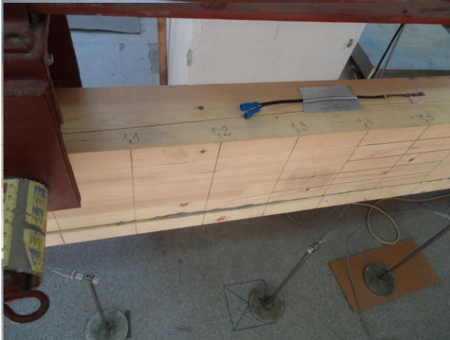
Слика 94. Проширење подужне пукотине
