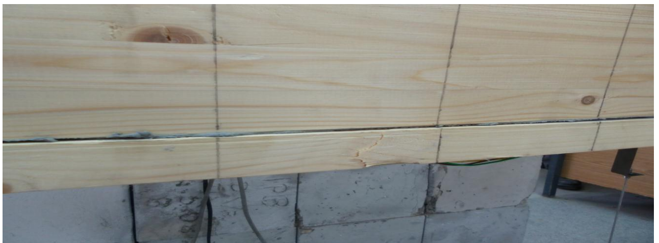
Слика 98. Лом доње ламеле на месту чворва
