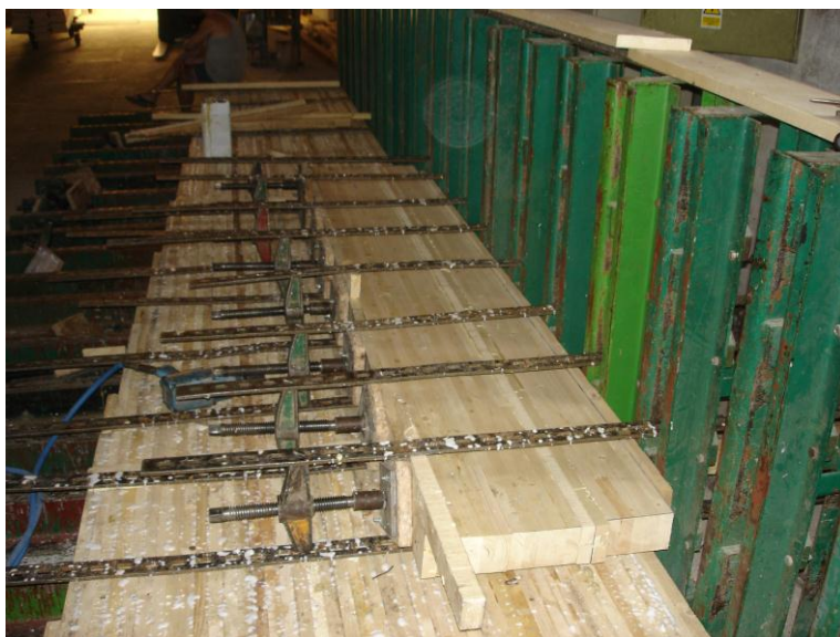
Слика 16. Израда узорка, лепљење ламела на писти помоћу механичких стега
