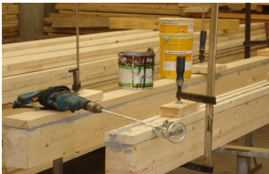
Слика 18. Израда модела, ручне стеге за накнадно лепљење доње ламеле
