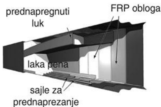
Слика 9. Приказ новог хибридног носача компаније HC Bridge [28]
