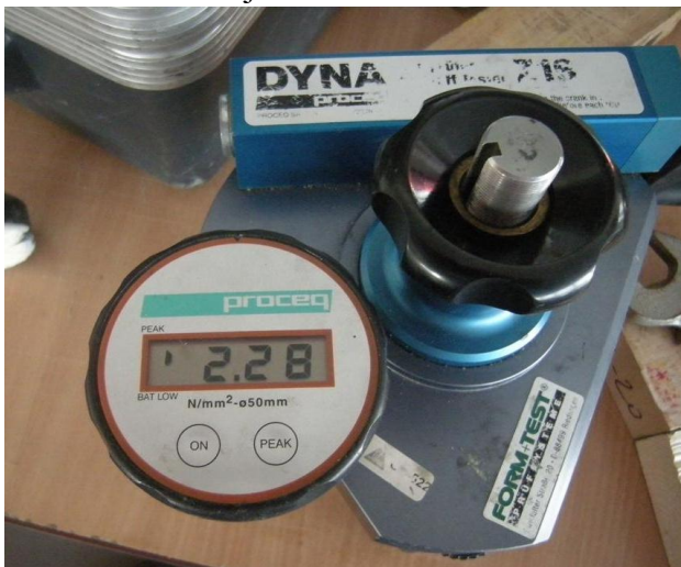
Слика 19. Уређај за мерење силе атхезије лепила и пологе узорка
