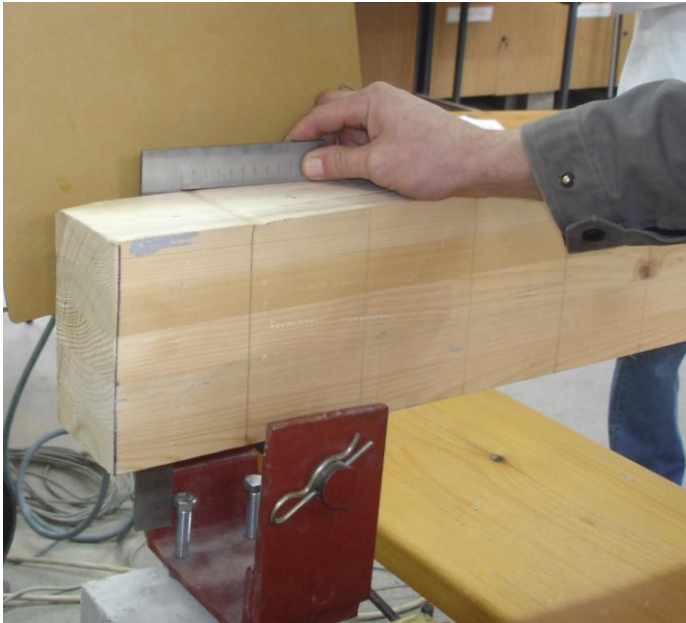
Слика 109. Гњечење влакана код левог ослонца Слика 110. Гњечење влакана код десног ослонца
