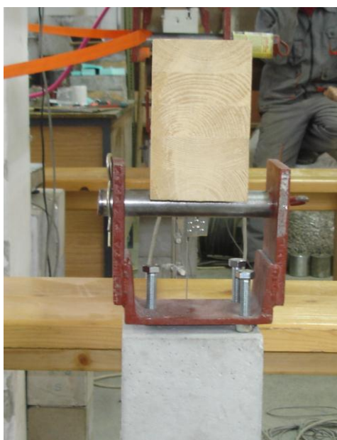
Слика 51. Идеално равно налегање Слика 52. Положај постављених мерних трака на греди
