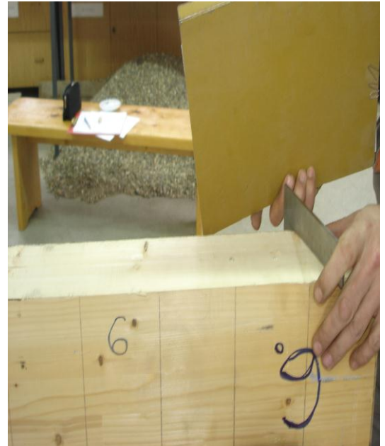
Слика 109. Гњечење влакана код левог ослонца Слика 110. Гњечење влакана код десног ослонца
