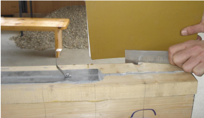
Слика 47. Детал FRP траке на накнадно залепљеној ламели Слика 48. Прслине попречног пресека
