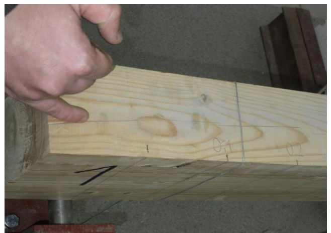
Слика 79. Прслина настала код израде узорка
