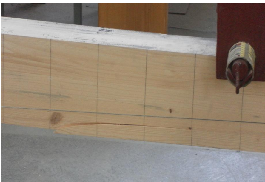
Слика 117. Локално зацепљење доње дрвене ламеле
