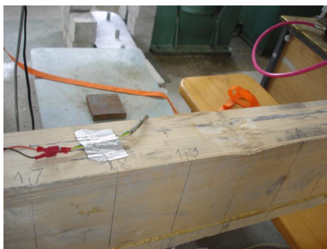
Слика 105. Гњечење влакана код ослонаца Слика 106. Гњечење влакана код ослонаца са површинским зацепљењем
