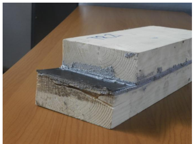
Слика 25. Зацепљење дрвене ламеле
