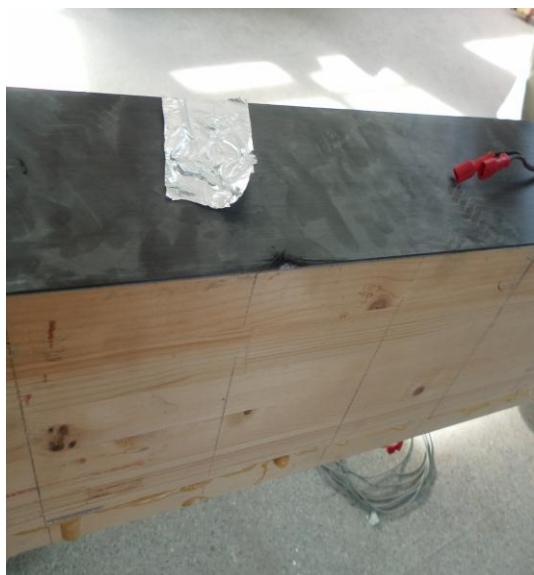
Слика 90. Зацепљење FRP траке
