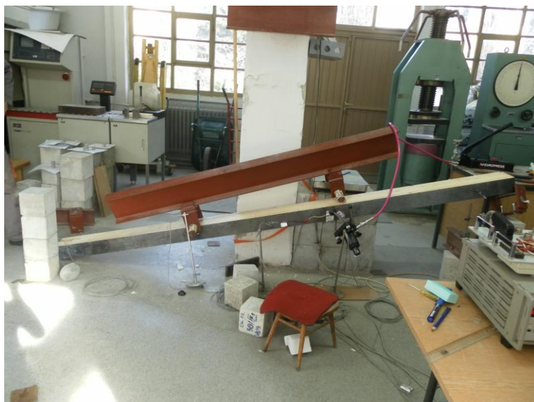
Слика 91. Претурање апаратуре услед избочавања
