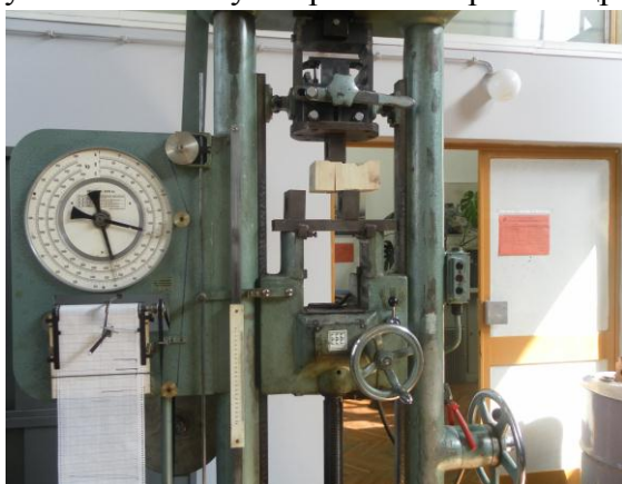
Слика 21. Преса за испитивање силе смицања са уређајем за цртање радног дијаграма
