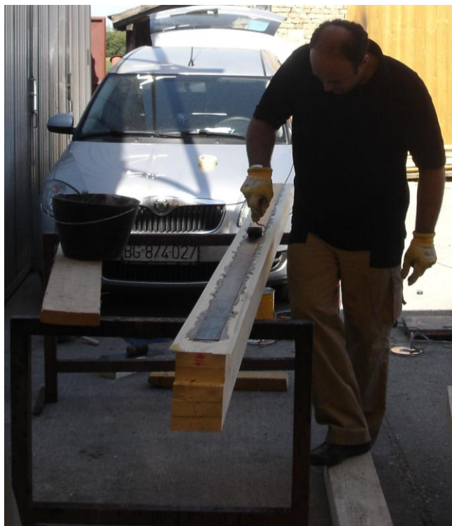
Слика 17. Ојачање узорка, лепљење FRP траке на доњој ламели
