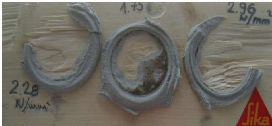
Слика 20. Испитивани отисци „pull off“ методом
