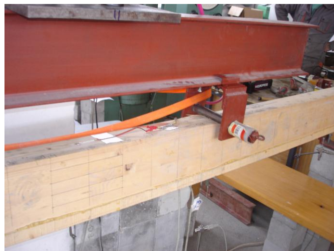
Слика 101. Гњечење влакана код уноса силе-лево Слика 102. Гњечење влакана код уноса силе десно
