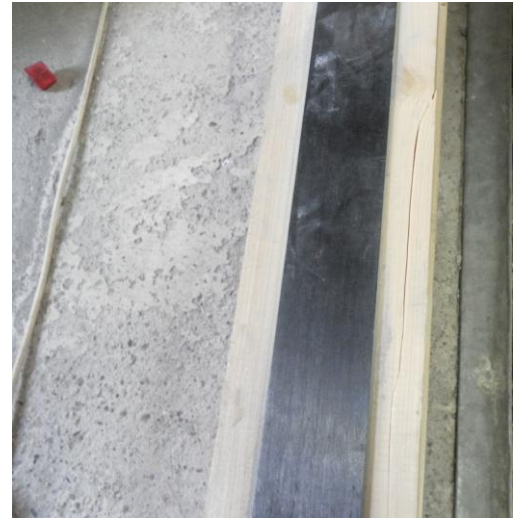
Слика 118. Локално зацепљење поред FRP траке Слика 119. Дужина локалног зацепљења
