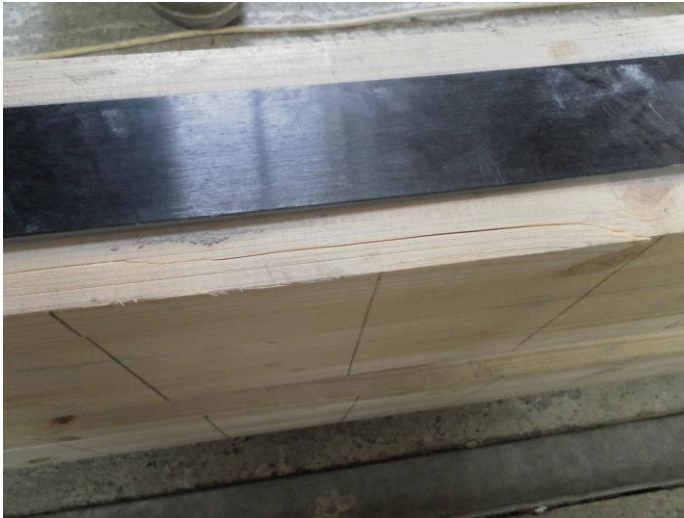
Слика 118. Локално зацепљење поред FRP траке Слика 119. Дужина локалног зацепљења
