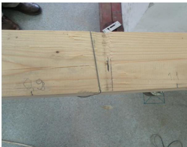
Слика 80. Гњечење дрвета код уноса силе
