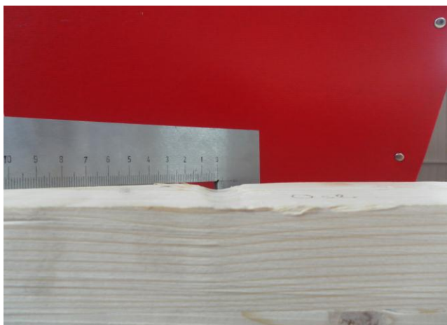
Слика 78. Гњечење дрвета код ослонца
