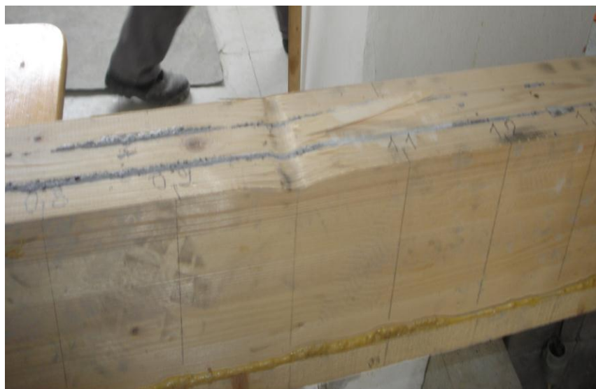
Слика 103. Гњечење влакана код ослонаца Слика 104. Вертикалне пукотине у дрвеним ламелама
