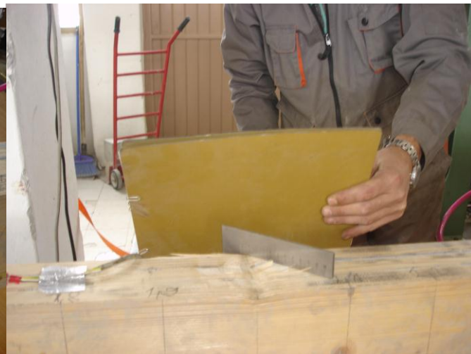
Слика 105. Гњечење влакана код ослонаца Слика 106. Гњечење влакана код ослонаца са површинским зацепљењем
