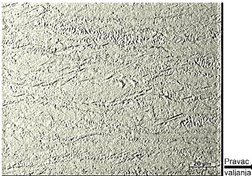
Slika 71.- Uzorak „L-2”- grupa I, ta ka: „O.S.” – 251,00HV0.25, po etna ta ka sa dijagrama slika 65, hladno-valjani lim sa stepenom deformacije = 66,6%. Uve anje x500. Jako izdužena zrna u pravcu hladne deformacije valjanjem
