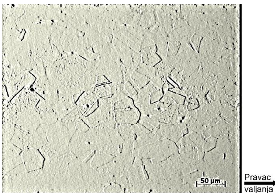
Slika 80.- Legura „L-2”- grupa II. Elementi obrade: temperature starenja t = 600^{\circ}\text{C} , vreme = 30 min, hla enje na vazduhu, ostvorena tvrdo a 170,50HV0.25, slika 67. Uve anje x200. Kristali ravnoosne strukture i delova dvojnika zaostalih u strukturi
