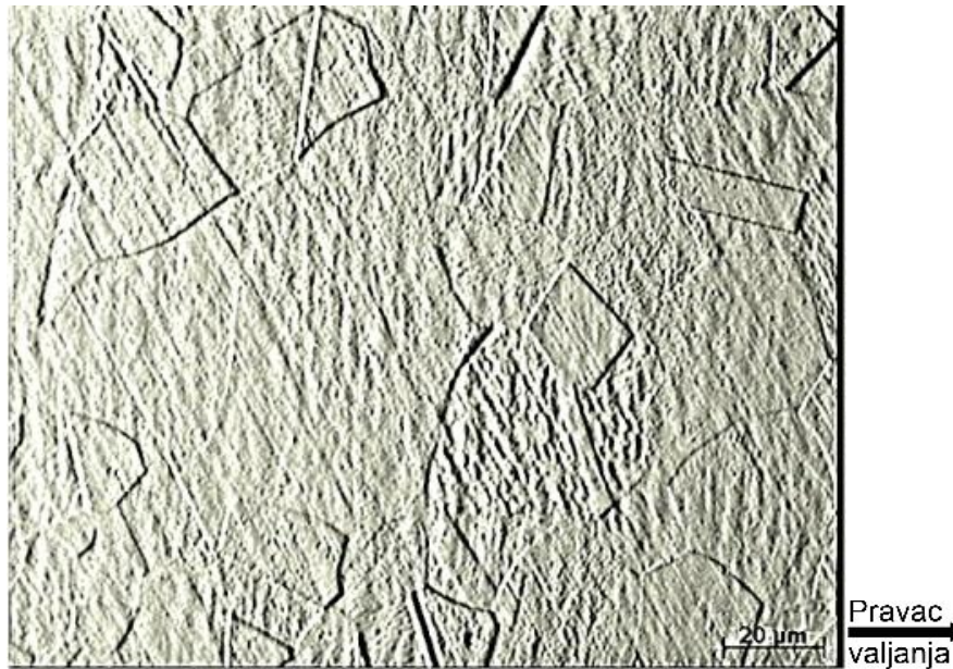
Slika 81.- Uzorak „L-2”- grupa II, kao slika 79. Uve anje x500. Ravnoosni kristali sa delovima dvojnika koji se utapaju u strukturi rekristalizacije
