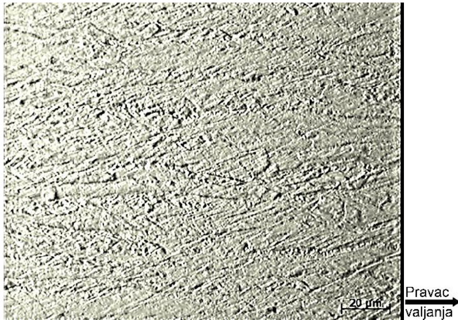
Slika 73.- Uzorak „L-2” – grupa I. Elementi obrade kao na slici 72. Uve anje x500. Izdužena zrna u pravcu valjanja sa izraženom pojavom dvojnika žarenja, koji se javljaju po grupama
