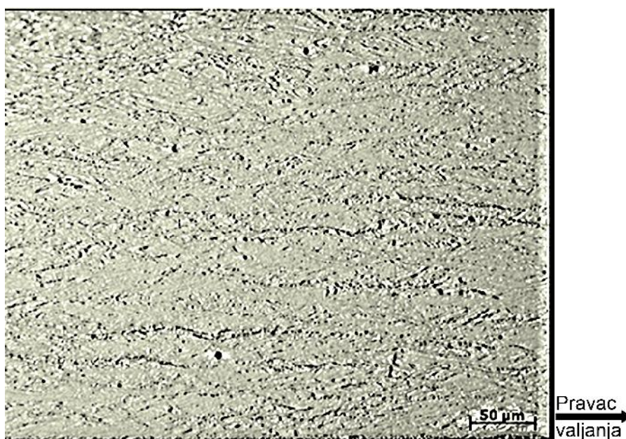
Slika 72.- Uzorak „L-2”- grupa I, elementi obrade: temperatura t = 300^{\circ}\text{C} , vreme = 30 min, hla enje na vazduhu, ostvorena tvrdo a 307,80HV0.25, na slike 65 i 66, maksimalno ostvorena tvrdo a na dijagramu. Uve anje x200. Izdužena zrna u pravcu valjanja sa veoma finim dvojnucima žarenja
