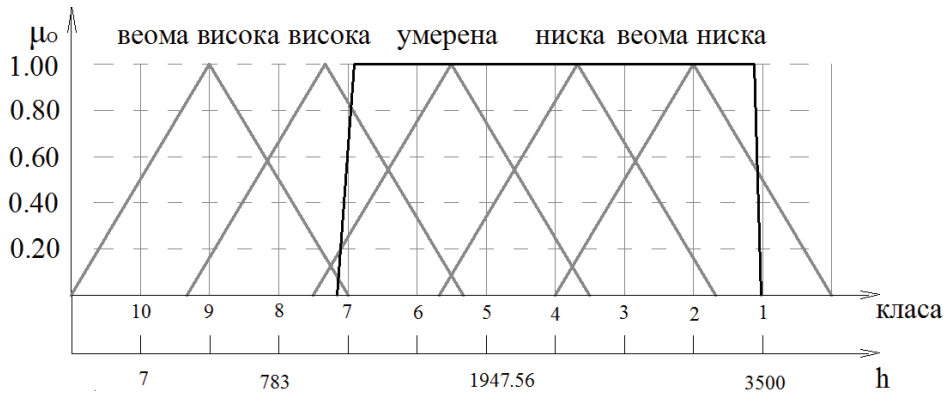
Слика број 5.21 Функција припадности учесталости појављивања отказа за главну хидропумпу
