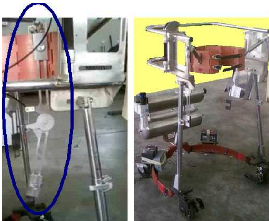
Slika 49, Hodalica sa ortozom za pokretanje kuka. Plavom bojom je uokvirena ortoza za pokret u kuku. Preuzeto iz [Kannik 2011].
