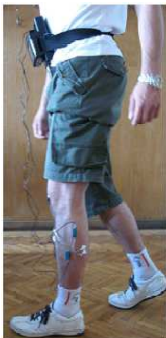
Slika 4, Levi panel: zdrav ispitanik hoda sa AceLAB uređajem (Tecnalia Serbia DOO, Beograd, Srbija); desni panel: uređaj povezan sa računarom i sa dva pretpojačavača.
