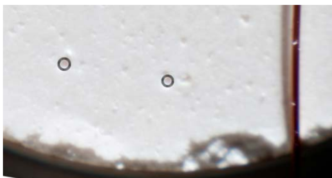
Slika 3.3. Fotografija površine mete nakon ozračavanja laserskim impulsom. Na slici su obeleženi krateri koje je izazvao laserski impuls. Izmeren prečnik kratera je 200 \mu\text{m} . Tanka bakarna žica prečnika 150 \mu\text{m} koja je na slici prikazana sa desne strane služi kao referenca.
