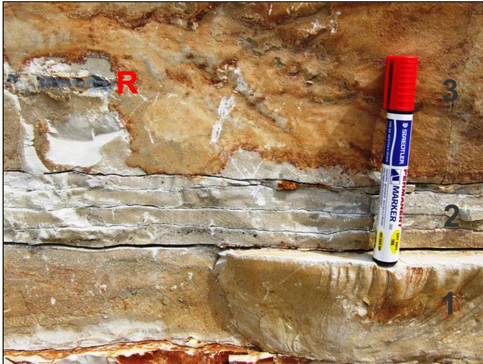
Slika 8.93. Slojevitost struganičkih mikritskih krečnjaka. 1 – sloj debljine 7 cm, 2 – veoma tanki slojevi (1-1.5 cm – na granici sa laminacijom) i 3 – sloj čija je debljina veća od 20 cm.
