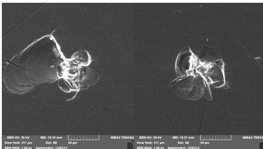
Slika 4.10.2.3. Intenzivna plastična deformacija koja nastaje nakon indentacije kod nanostrukturnog HAp-a.
