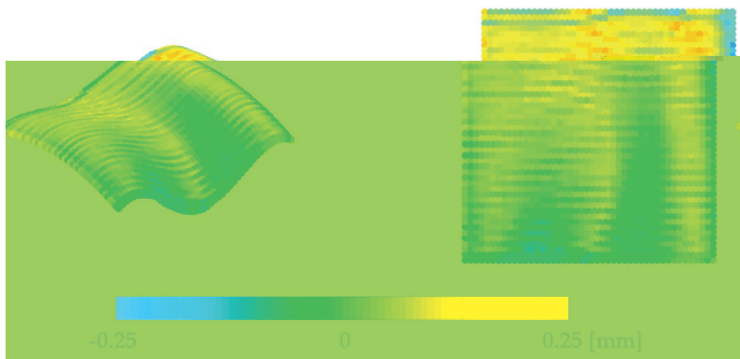
Слика 7.21 – Мапа девијације за део обрађен вишекритеријумском оптимизацијом путање алата
