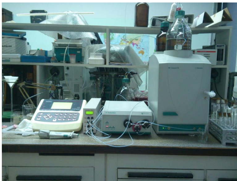
Slika 5.2 Metrom 761 Compact IC za jonsku hromatografiju korišćen u ovom radu
