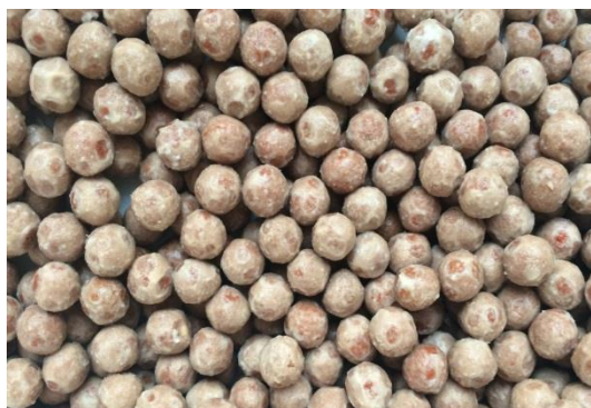
Slika 7.3. Keramičke kuglice sa formiranim biofilmom
