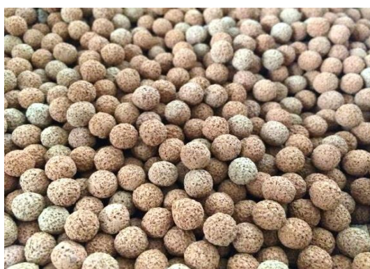
Slika 7.2 . Nosači mikroorganizama-keramičke kuglice
