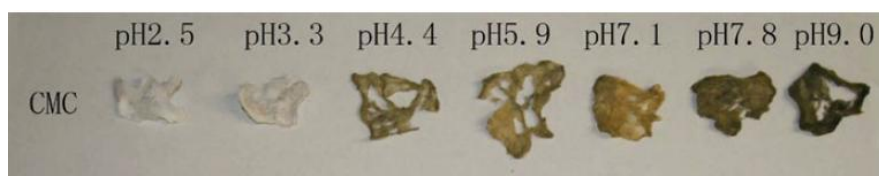
Slika 3.2. Promena boje CMC vlakana sa srebrom u zavisnosti od pH koloidnih rastvora AgNP [89]
