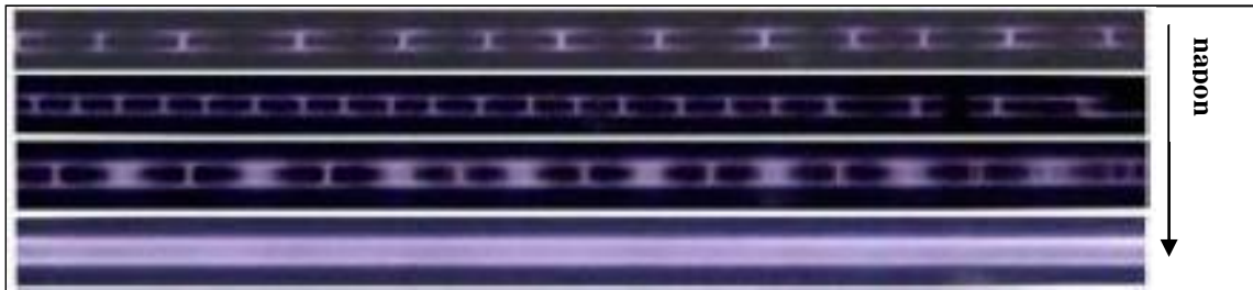
Slika 2.5. Izgled filamentarnog pražnjenja sa povećanjem napona na elektrodama [42]
