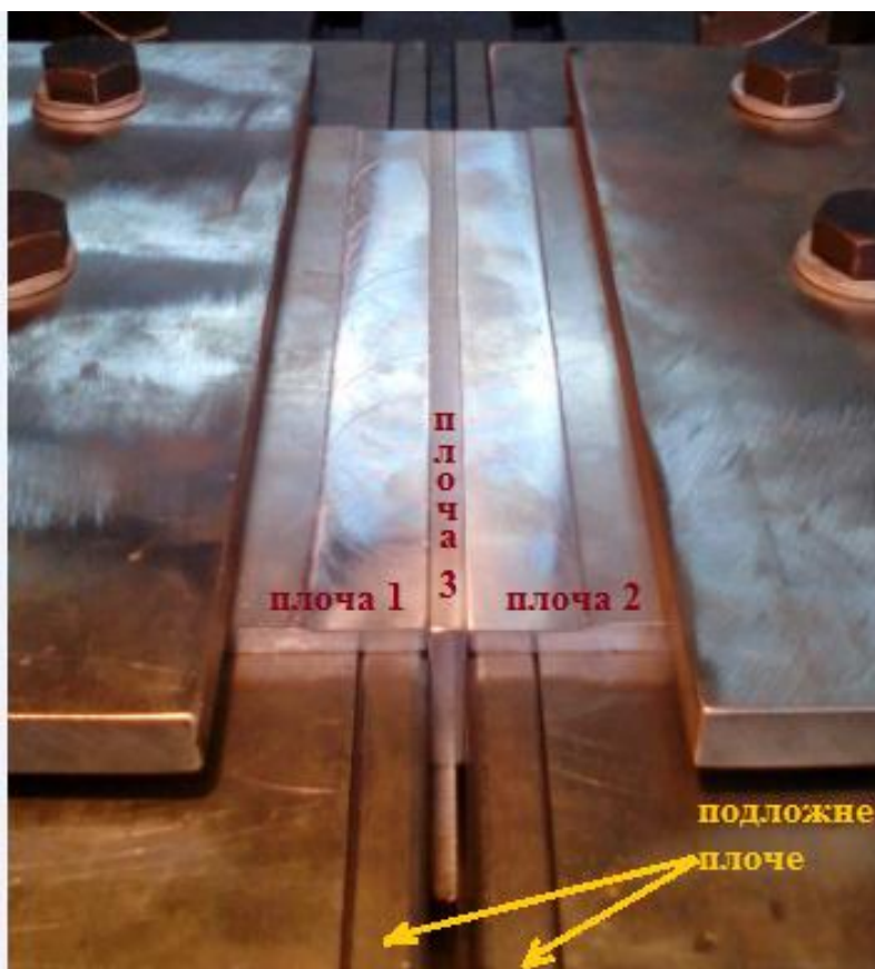
Слика 5.1 Стегнуте плоче на радни сто машине, проба 4.1
