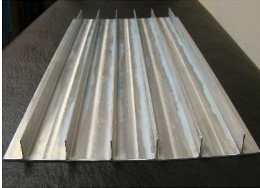
Слика 3.2 Заваривање палубе брода [64]
