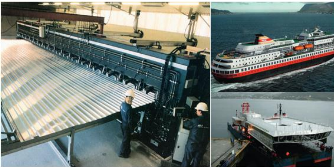
Слика 2.35 ESAB SuperStir у бродоградилушту „Marine Aluminium“, велики бродови као типични примери на којима се заварују панели поступком ЗТМ [6]
