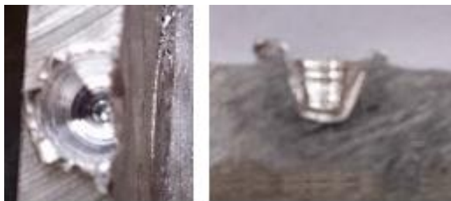
Слика 5.3 Изглед отиска трна алата и почетак секундарног течења материјала
