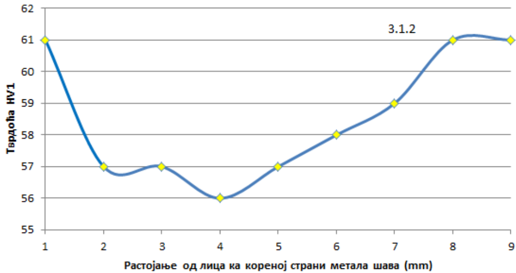
Слика 5.12 Расподела и места мерења микротврдоће кроз пресек споја 3.1 а) узорак 3.1.1 и б) узорак 3.1.2
