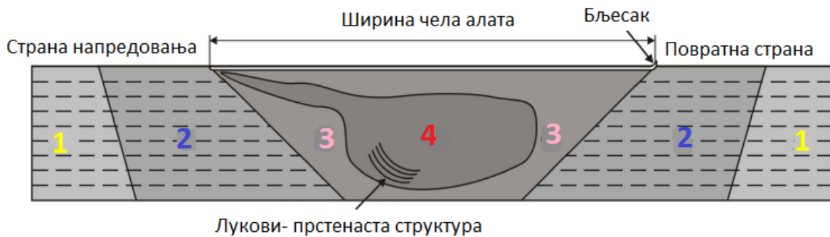
Слика 2.11 Структура завареног споја поступком ЗТМ [23]
