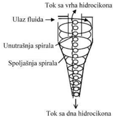
Slika 5.20. Hirociklonski desalter (Bai i Wang, 2007)
