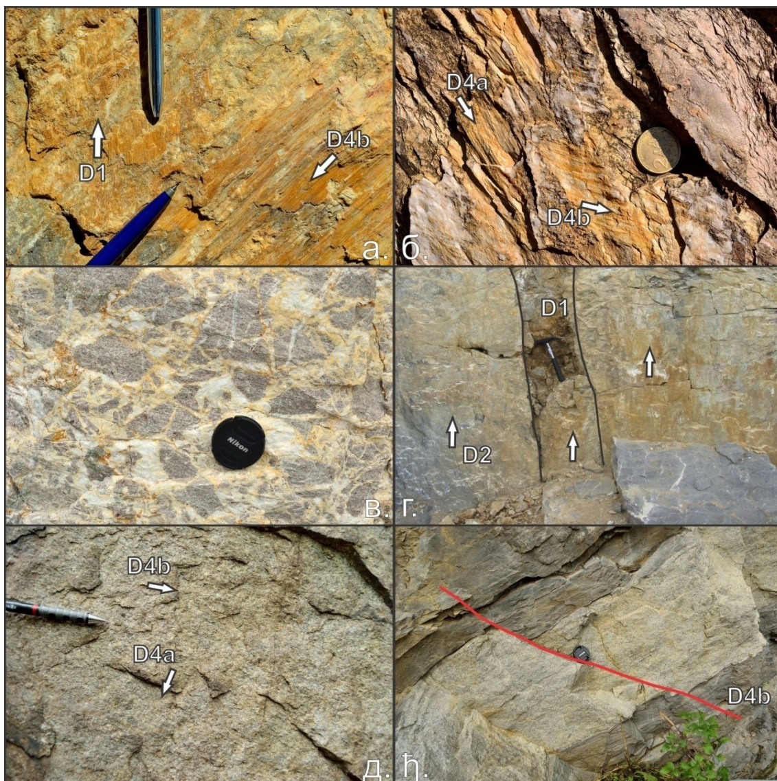
Слика 4.3. Опсервирани индикатори кретања на раседним површима: а, б – односи пресецања и прекривања (cross – cutting relationships) стрија на раседним површима; в – компактна раседна бреча, као резултат релативно дубоке (али у домену кртих деформација) тектонске активности; г – односи пресецања раседа; д – односи пресецања и прекривања стрија, опсервирани у средњомиоценском граниту Полумира; ђ – расед који сече дајк (?) полумирског гранита, указујући на тај начин да је био активан у најмлађој тектонској фази.
