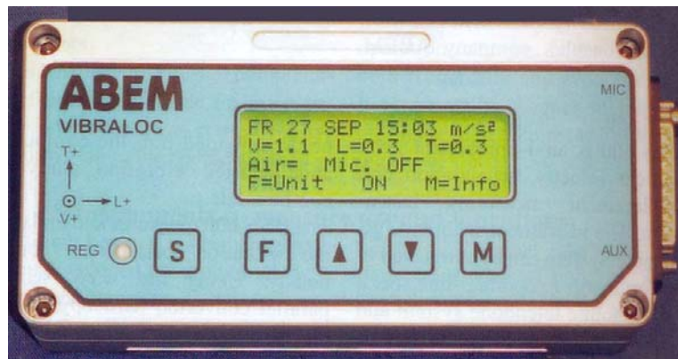
Slika 3-9. Prikaz izmerenih podataka na displeju [96]
