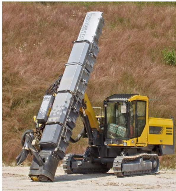
Slika 2-45. "Pametna" garnitura za bušenje ( Smart Rig ) ROC D7C kompanije Atlas Copco sa opremom za prigušenje buke za približno 10 dB[83]
