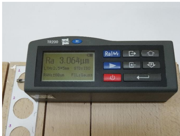
Slika 34. Merenje parametra hrapavosti površine nakon brušenja
