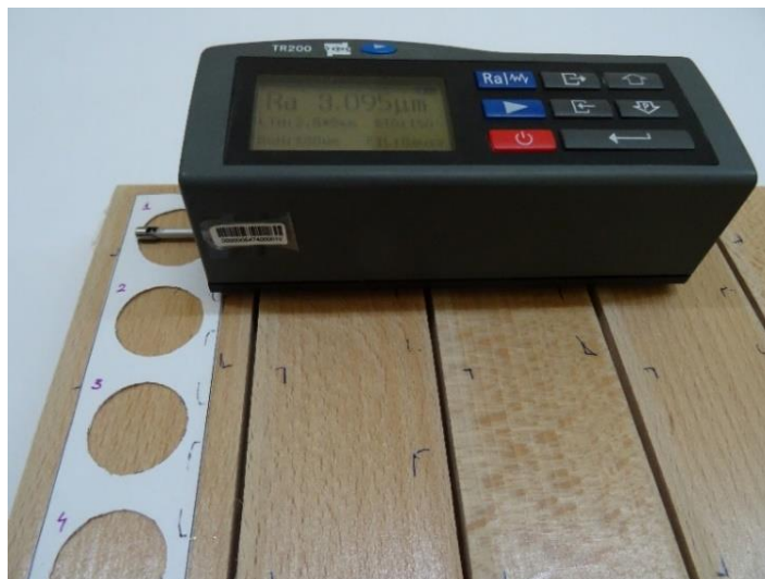
Slika 48. Određivanje parametra hrapavosti lakirane površine
