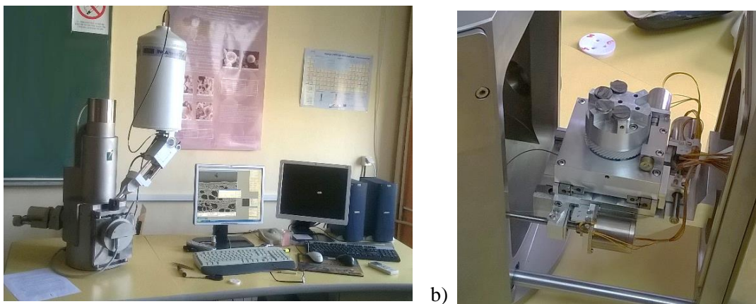
Slika 46. SEM i oprema: a) radno mesto skenirajućeg elektronskog mikroskopa; b) postolje sa nosačima i nalepljenim uzorcima
