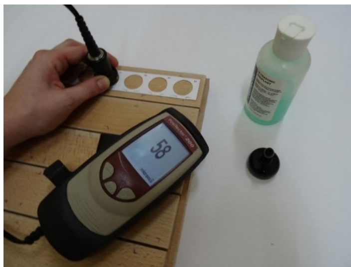
Slika 47. Merenje debljine suvog filma premaza metodom ultrazvučnog merača
