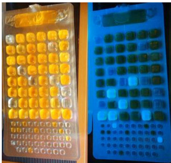
Slika 3.7. Određivanje najverovatnijeg broja koliforma pomoću Colilert 18 sistema
