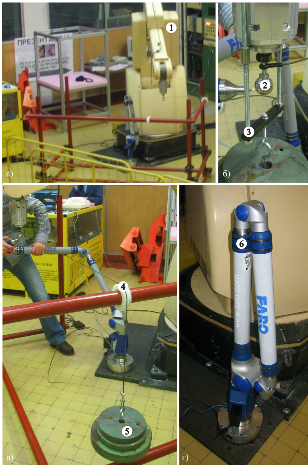
Слика 4.3: Експеримент мерења помераја врха робота
