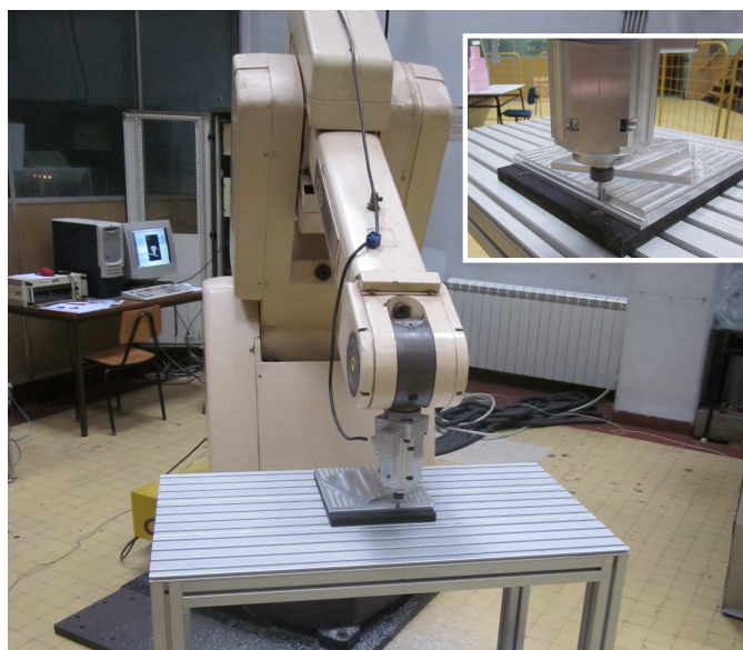
Слика 6.6: Обрада контуре квадрата на тест радном делу на роботу ЛОЛА50
