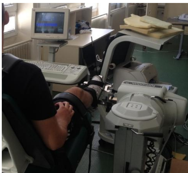
Слика 10. Мерење механичких карактеристика екстензора и флексора скочног зглоба
