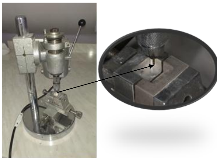
Slika 4. Stona bušilica za preparaciju kaviteta na dentinskim diskovima
