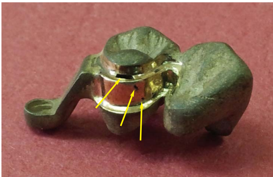
Slika 7. Greške u livenju uočljive na frezovanom mestu namenske krunice sa atečmenom
