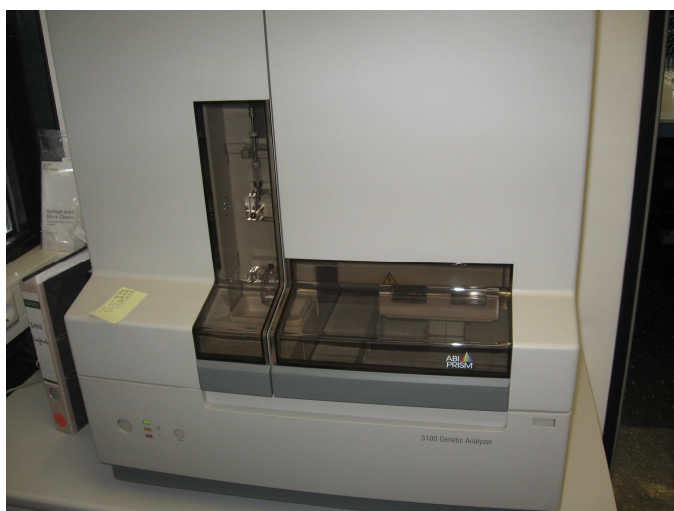
Slika 40: Genetic Analyser-uređaj za kapilarnu elektroforezu ABI PRISM 3100 u laboratoriji Katedre za Šumarsku genetiku Šumarskog fakulteta u Getingenu, Nemačka
