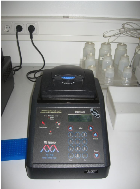
Slika 37: PCR uređaj MJ RESEARCH u laboratoriji Katedre za šumarsku genetiku Šumarskog fakulteta u Getingenu, Nemačka
