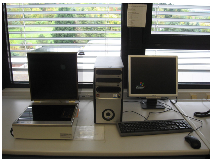
Slika 39: Uređaj za vizuelizaciju produkata elektroforeze na agaroznom gelu ultraljubičastim osvetljenjem u laboratoriji Katedre za Šumarsku genetiku Šumarskog fakulteta u Getingenu, Nemačka
