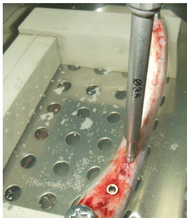
Slika 5. Preparacija implantatnih ležišta četvrte grupe tehnikom lateralne kondenzacije, kondenzatorom finalnog dijametra 3,5 mm (Aesculap Bone Condenser ® , FourSquare HealthCare, Silsden, UK)
