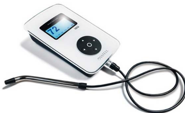
Slika 1. Aparat za merenje implantatne stabilnosti RFA metodom
