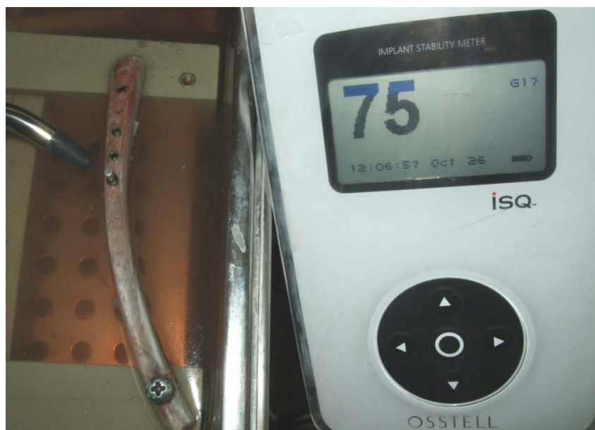
Slika 8. Merenje primarne stabilnosti neurezujućih implantata (Standard, Institut Straumann AG ® , Valdenburg, Švajcarska)
