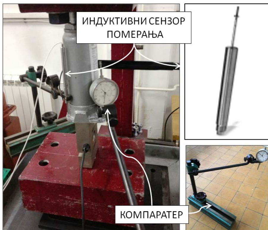
Слика 7.12. Инструменти за мерење угиба
