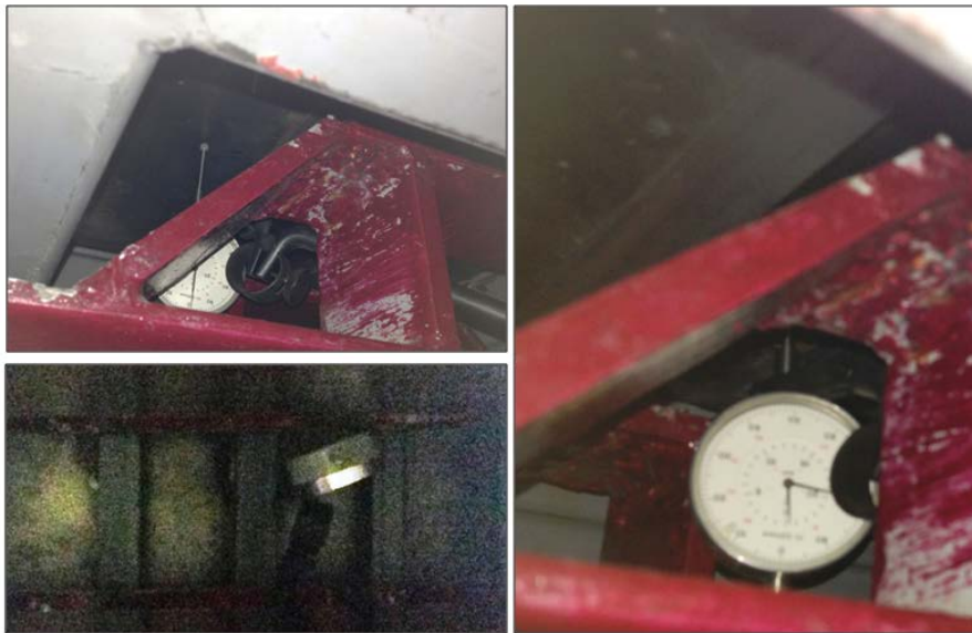
Слика 7.13. Позиција компаратера директно на плочи између укрућења
