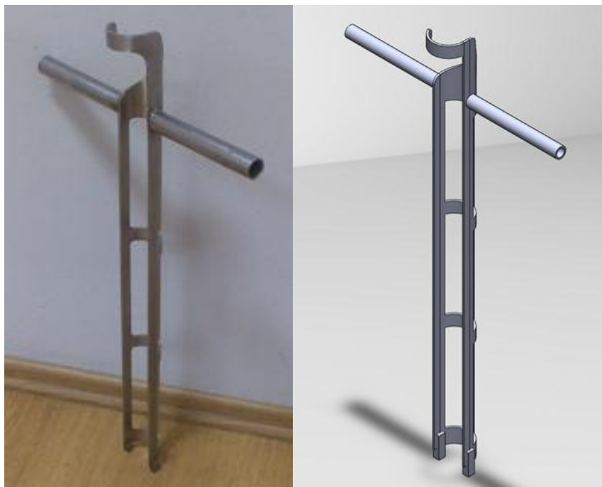
Slika 2.1. Mašinski deo i njemu odgovarajući 3D model
