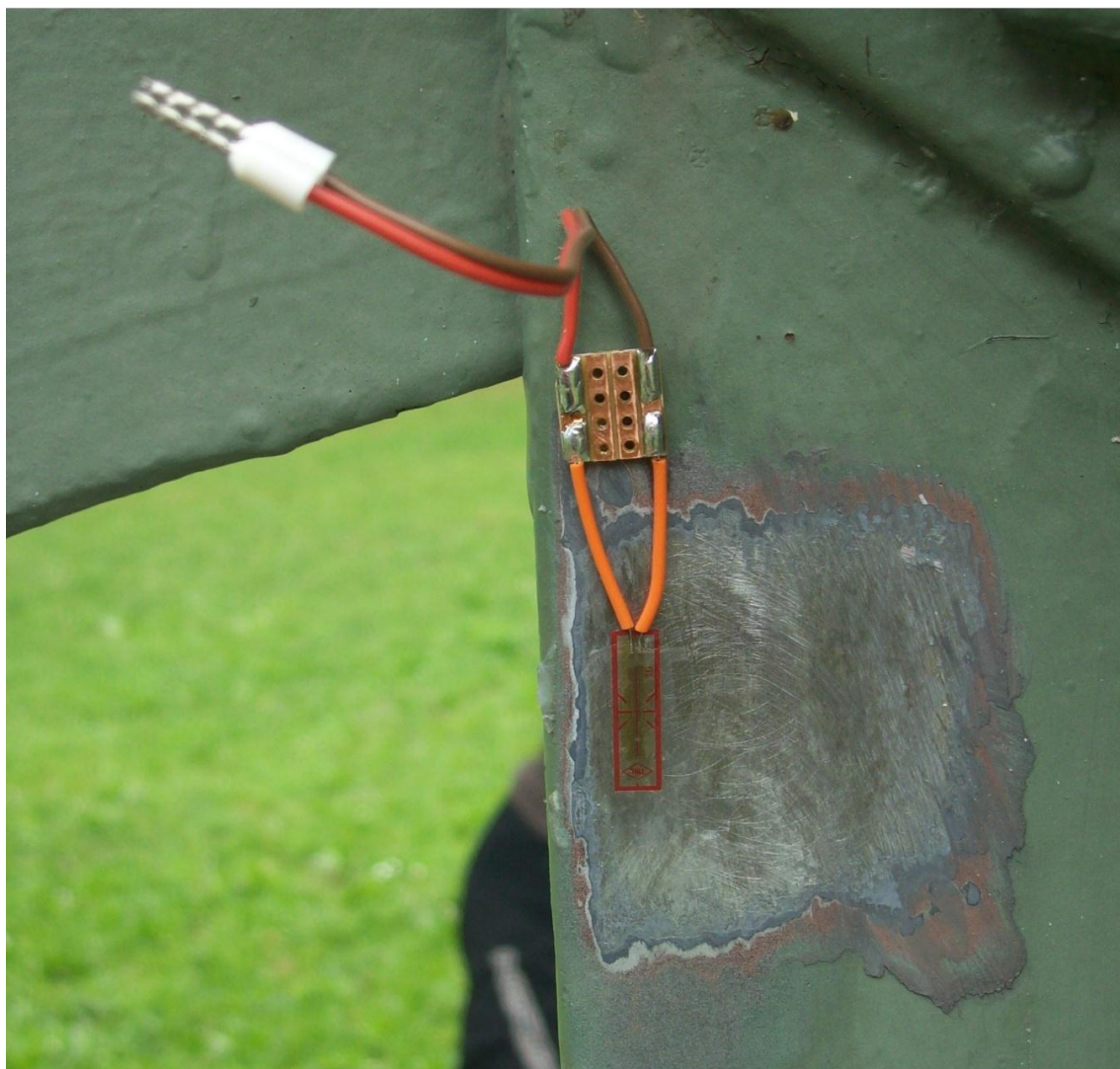
Slika 4.3. Fiksirana merna traka
