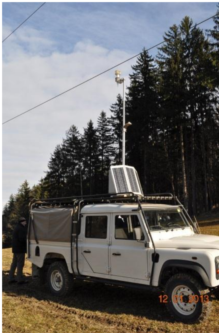
Slika 4.2. Mobilna meteorološka stanica
