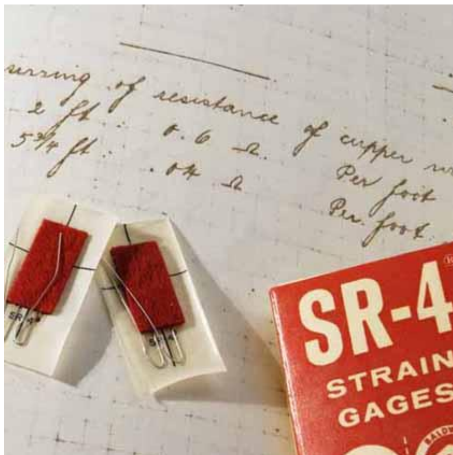
Slika 4.11. Izgled prvih mernih traka
