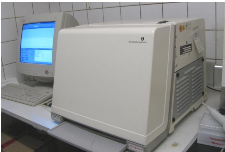
Slika 17. Automatski sekvenator ALFexpress II (GE Healthcare) za lasersko očitavanje amplifikovanih fragmenata DNK. Thünen Institut za šumarsku genetiku, Grosshansdorf, Germany (Čortan 2014).
