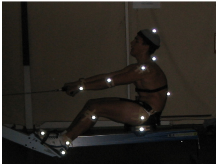
Slika br. 33 Detalj sa atesta eksperimenta (praćenje kinematičkih tačaka)
