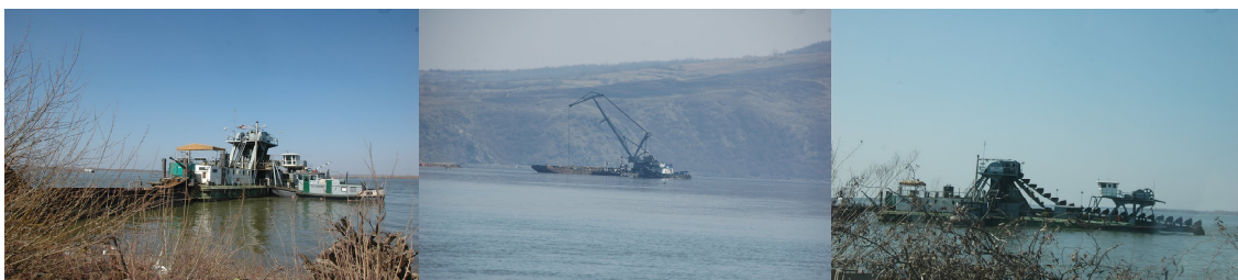
Slika 3.3. Primeri bagera za eksploataciju šljunka sa dna rečnog korita
