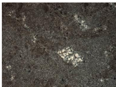
Sl. 91. Belovode. Grupa IX, ostalo: mikrofotografija uzorka 198, devitrifikovan i i silifikovan tuf (po Cvetković i Šarić 2010).
