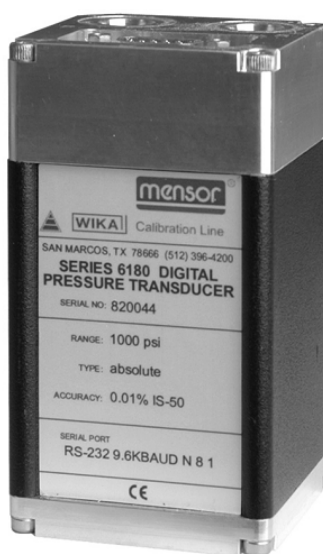
SI. 52. Digitalni davač pritiska Mensor tipa CPT6180, [66]
