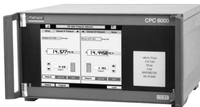
Sl. 54. Kalibrator pritiska tipa Mensor CPC 6000 , [67]
